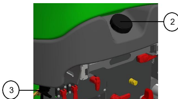
Figura 6.16 – Ex. depósitos água limpa
