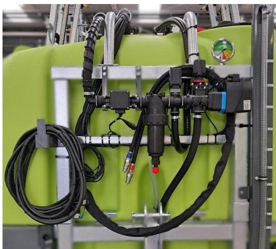
Figura 5.11 – Arrumação de cabos e mangueiras.
