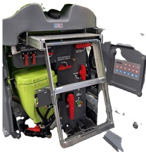
Figura 4.3 – Escada de acesso do Pulverizador PRIME
