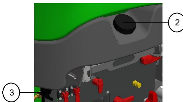
Figure 6.16 – Ex. réservoirs d'eau propre
