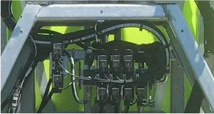
Figure 8.2 – Exemple de bloc électrohydraulique.
