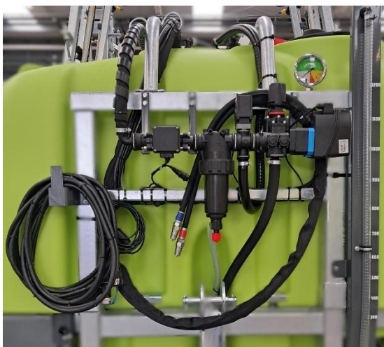
Figure 5.11 – Rangement des câbles et des tuyaux.
