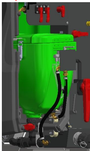
Figura 4.7 – Depósito de mezcla de productos (Premezcla)
