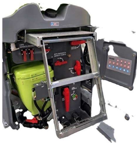
Figura 4.3 – Escalera de acceso al pulverizador PRIME
