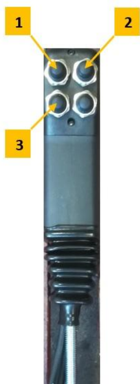
Figura 7.2 – Unidade de Comando electro-hidráulico – Joystick
