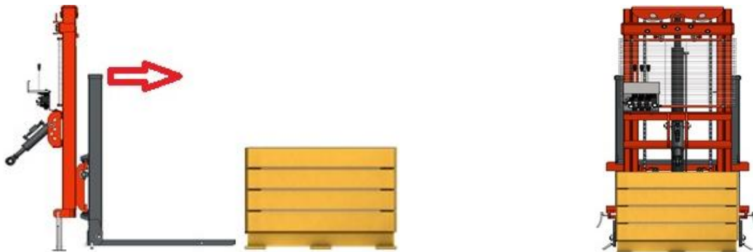
Figura 7.5 – Posicionamento dos garfos do empilhador na carga a manipular.
