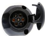
Figura 5.23 – Ex. Tomada elétrica 7 pinos
