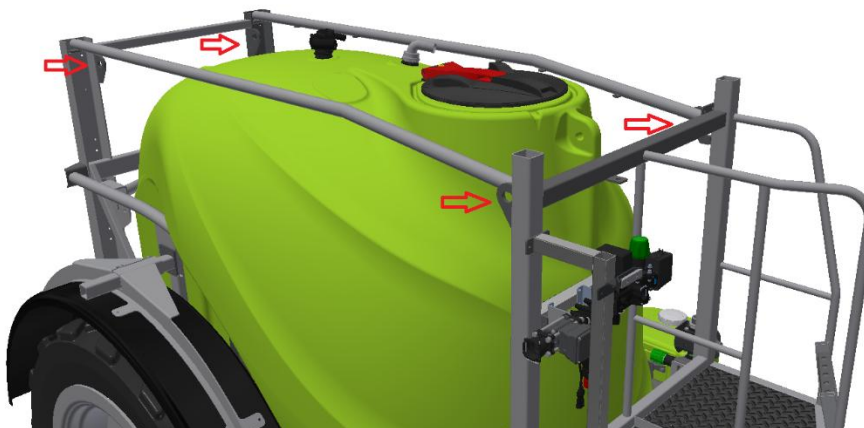
Figura 5.1 – Pontos para elevação do Pulverizador na descarga.
