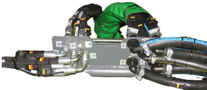
Figura 5.10 – Ex. ligação de mangueiras dos circuitos óleo e água
