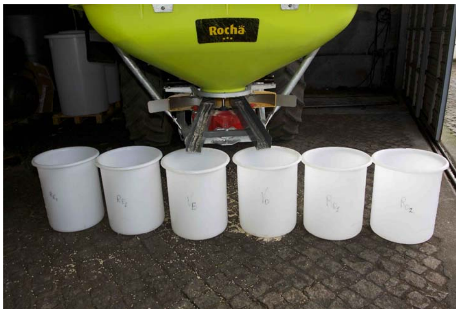
Figura 1. Distribuidor de adubo preparado para os ensaios estáticos do fluxo de adubo. Foto: Pulverizadores Rocha, SA.
